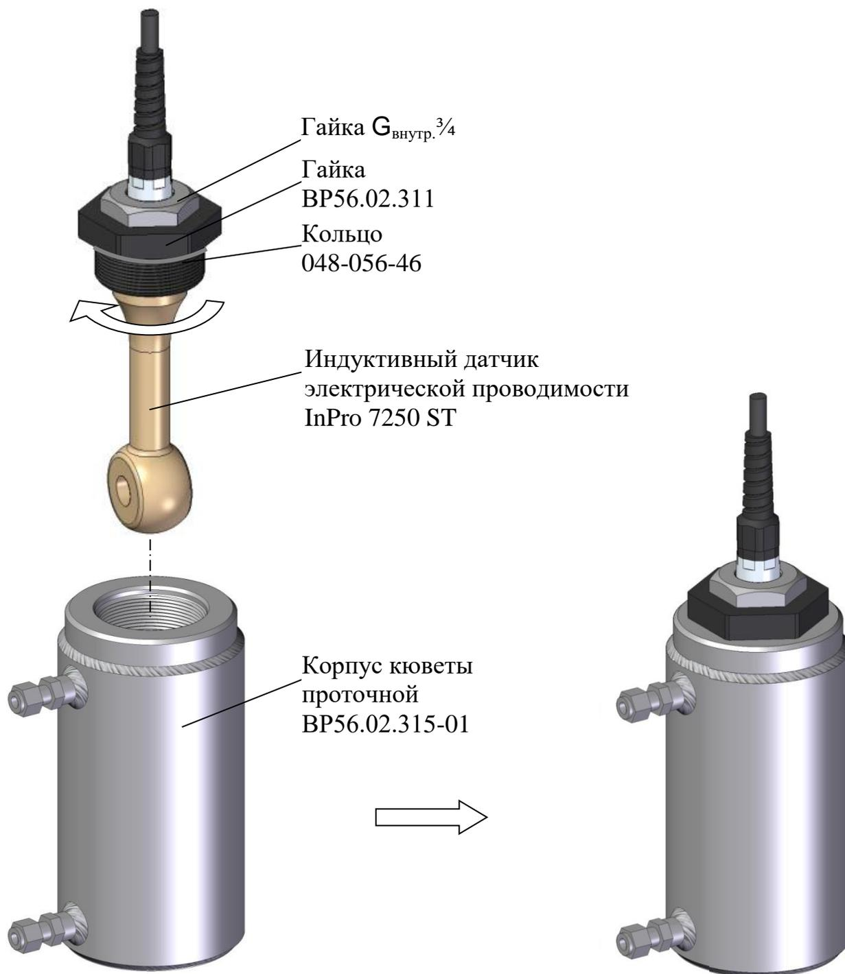
*Рисунок 2.10 – Расположение датчика проводимости InPro 7250 ST
