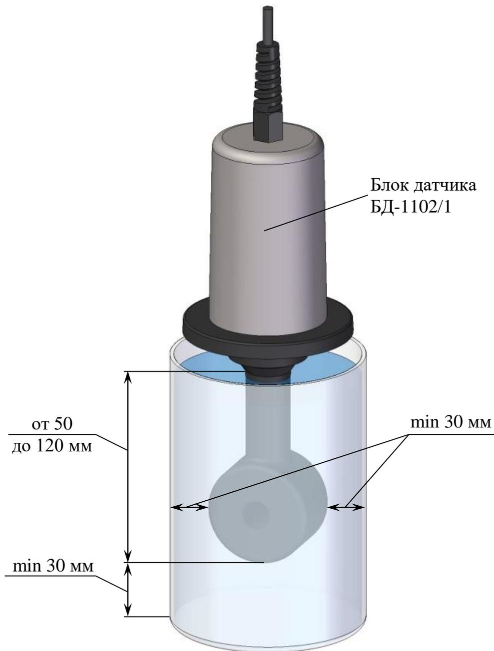
*Рисунок 2.16 – Расположение блока датчика БД-1102/1 при проведении измерений погружным способом*
