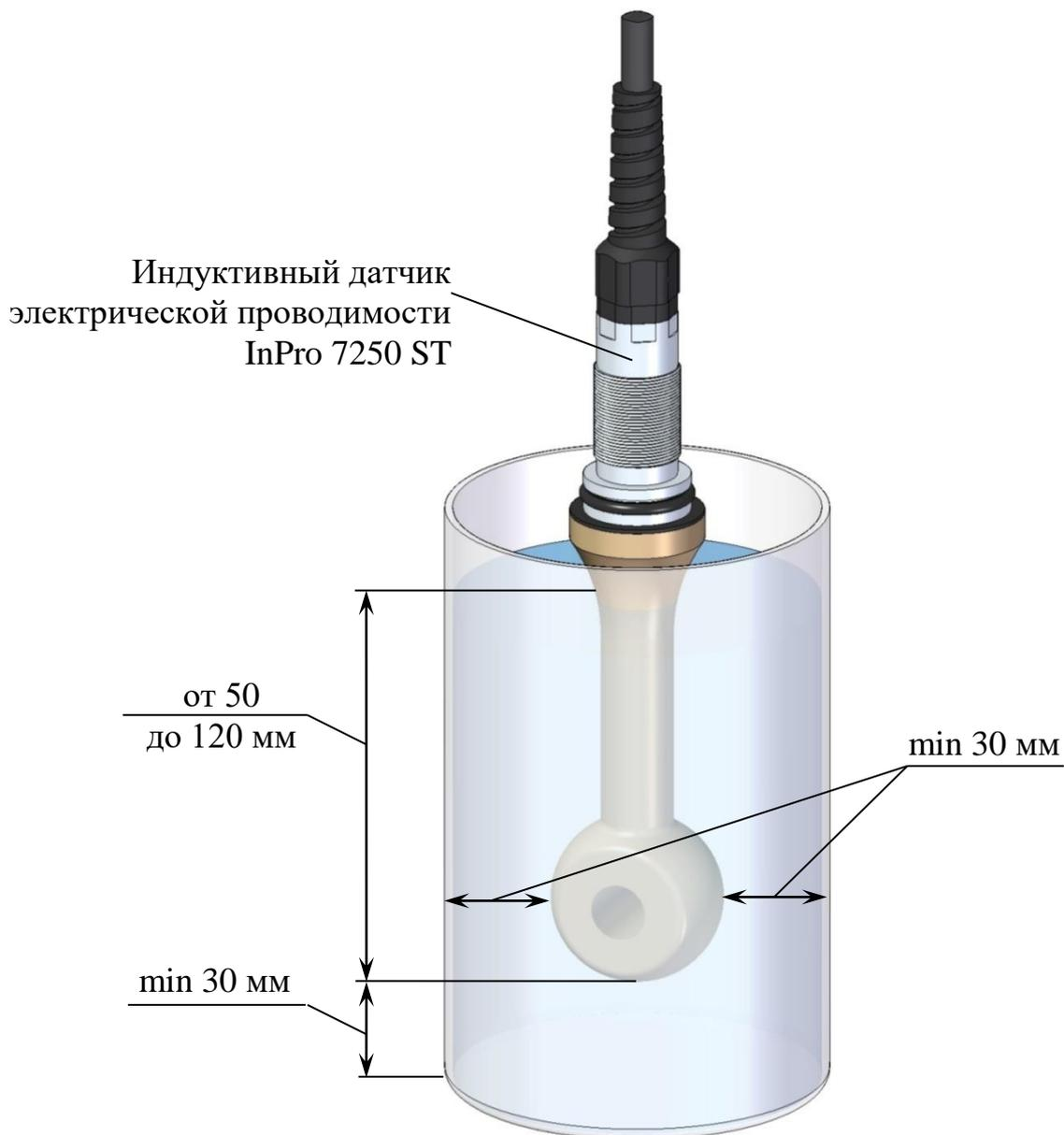
*Рисунок 2.12 – Расположение датчика проводимости InPro 7250 ST при погружном способе проведения измерений*
