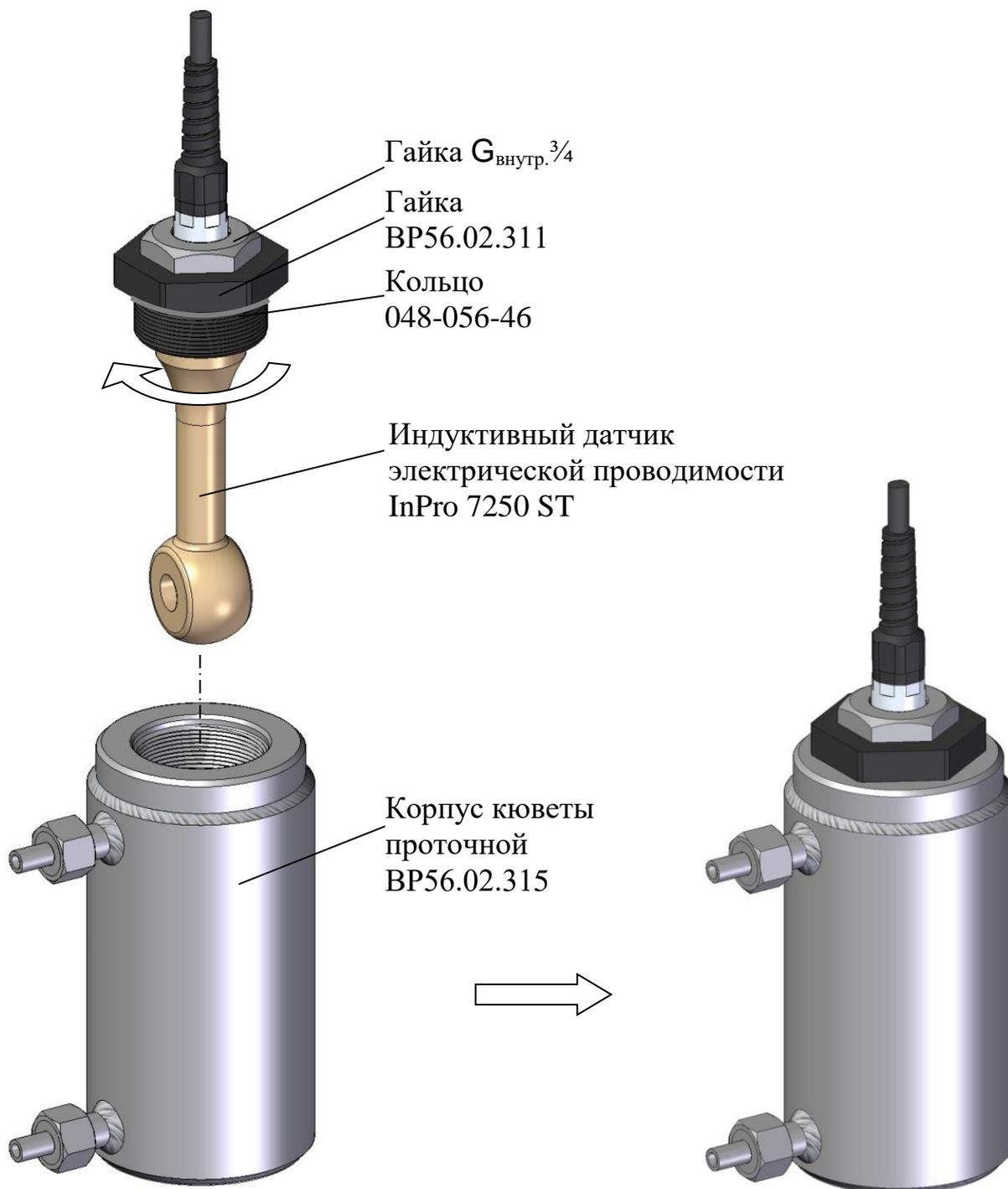
*Рисунок 2.9 – Расположение датчика проводимости InPro 7250 ST
