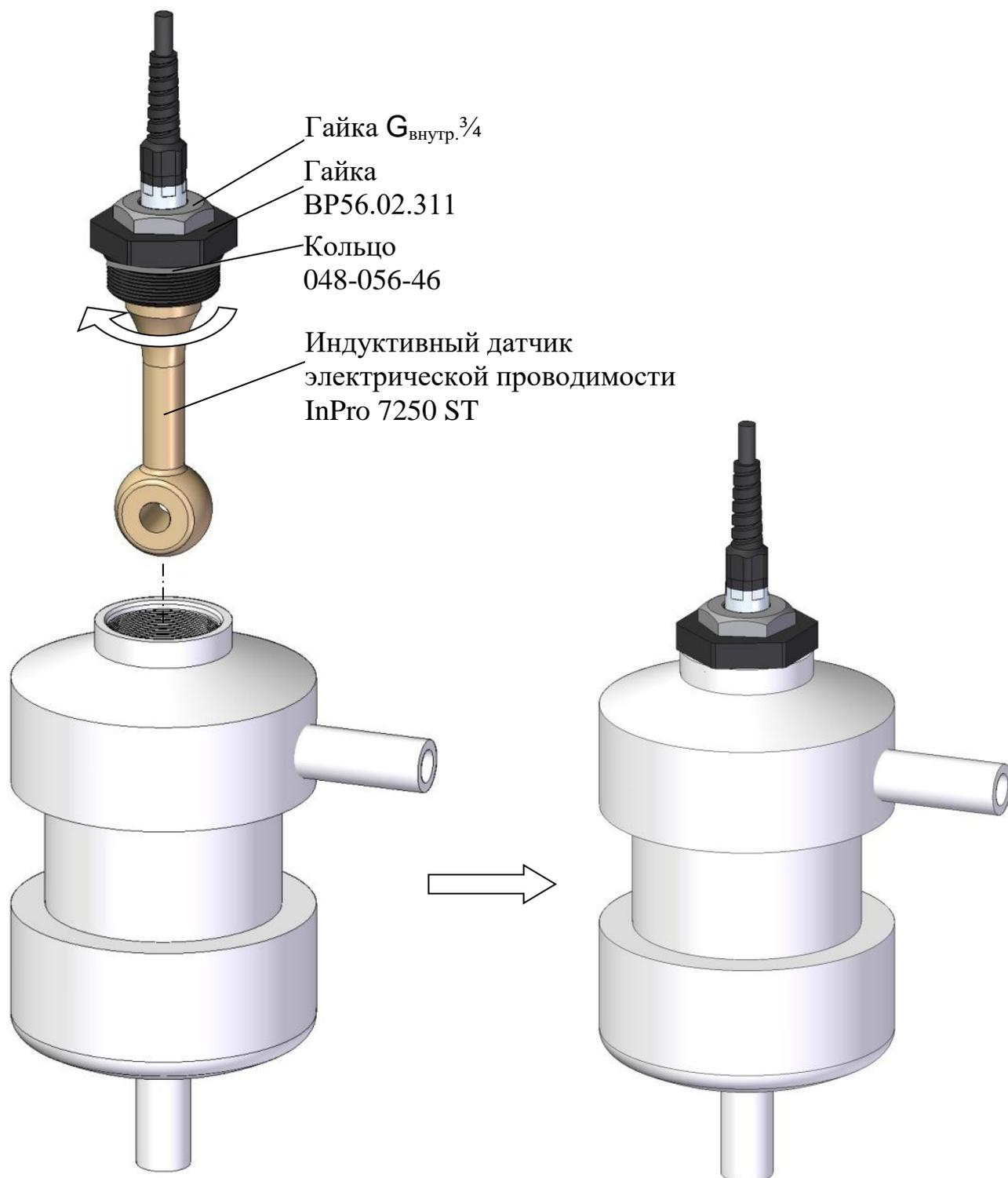
*Рисунок 2.11 – Расположение датчика проводимости InPro 7250 ST
