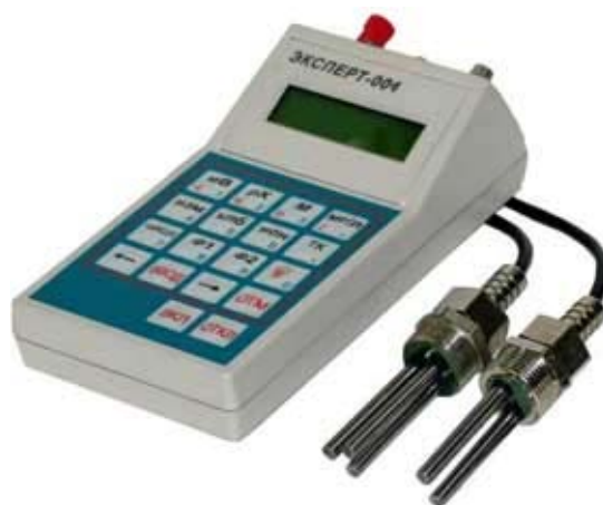
Коррозиметр «Эксперт-004» в комплекте с датчиками
