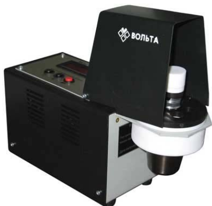
Датчик «Модуль ЕМ-04» с вращающимся дисковым электродом
