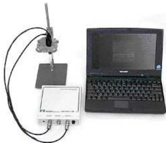
Комплект для полевых измерений с микроэлектродом
